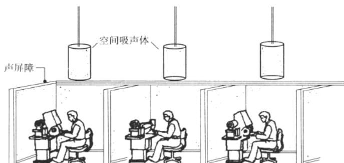
图 3.3-39 在大型制造车间里同时用半高的声屏障与空间吸声体抑制噪声
