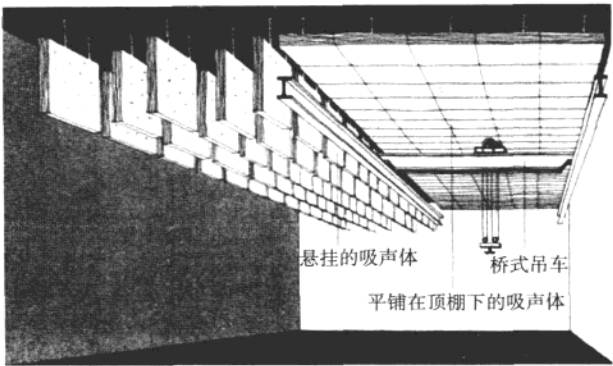
图 3.3-40 大尺度生产车间里的吸声降噪措施举例 资料来源: Noise/News International [J], Vol. 4, No. 1, P. 45, 1996
