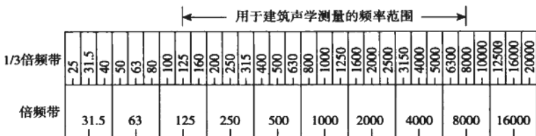
图 3.1-6 为了对声音进行测量和分析，将可听声音的频率范围分成倍频带和 1/3 倍频带
